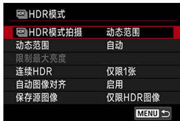
适合于风景和静物拍摄。每次拍摄，将以不同的曝光拍摄三张图像(标准曝光、曝光不足和曝光过度)，然后自动合并在一起。
