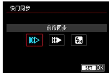
通常，将此选项设为[前帘同步]，以便闪光灯在拍摄开始后立即闪光。设定为[后帘同步]并使用较慢的快门速度，可拍摄自然的被摄体运动轨迹图像，如汽车前灯等。
