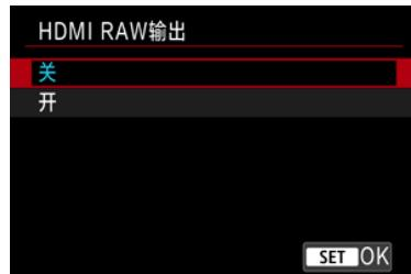
设为[开]可将RAW短片以最高6K的分辨率从HDMI端子输出到兼容设备。
