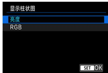
柱状图显示贯穿色调范围的信号量。可进行亮度显示(用于查看总体的曝光量和整体的色调层次)和RGB显示(用于查看红色、绿色与蓝色的饱和度和色调层次)。在[▶: 播放信息显示]屏幕的左下角中显示[INFO]时，通过按<INFO>按钮可以切换显示的柱状图。
