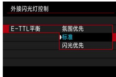
可为闪光拍摄设定所需的光线效果(平衡)。此设置可调整环境光照与闪光灯光照输出的比率。
