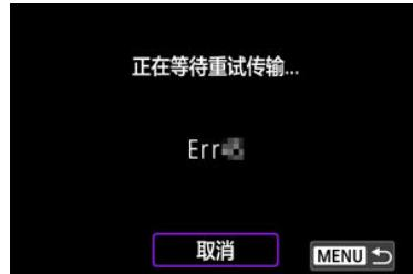
问题解决后，将会自动传输原本无法发送的图像。启用此选项时，无论是在使用自动传输时或通过FTP手动传输拍摄的图像时，传输失败后都会自动尝试重新传输。请注意，如果取消传输或关闭相机，则不会尝试自动重试。
