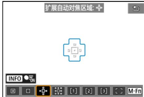
使用一个自动对焦点[□]和由蓝框包围的自动对焦区域进行对焦。这对使用单点自动对焦进行追踪比较困难的移动被摄体比较有效。
