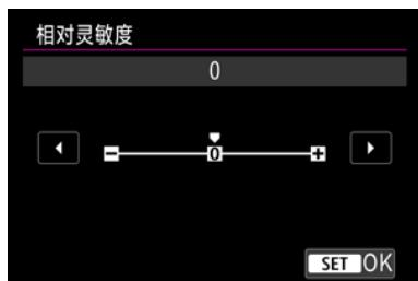
要加快自动对焦点定位，向正方向设定，要减慢定位，向负方向设定。
