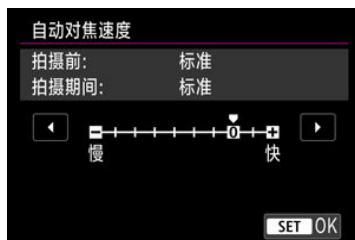
可以将自动对焦速度(对焦转变速度)从标准速度(0)调整为慢(分为七个级别)或快(分为两个级别)，以获得所需的短片创建效果。
