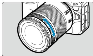
默认情况下，可在<**Fv**>、<**P**>、<**Tv**>、<**Av**>或<**M**>模式下半按快门按钮的同时，通过转动RF镜头或卡口适配器上的控制环来设定曝光补偿。或者，可通过在[**自定义转盘**] (图)中自定义操作来为控制环分配不同的功能。
