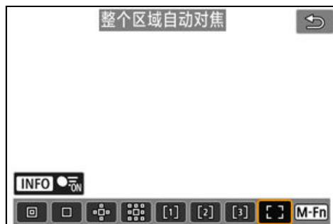
整个区域自动对焦框比灵活区域自动对焦覆盖的对焦范围更大，因此与使用单点自动对焦/扩展自动对焦区域/灵活区域自动对焦相比，在整个区域自动对焦框中使用自动选择对焦，更容易对焦被摄体，且对移动被摄体也有效。
