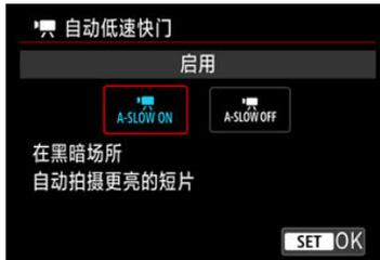
可选择是否在低光照下自动降低快门速度，使记录的短片比设为[关闭]时更明亮、受图像噪点影响更小。
