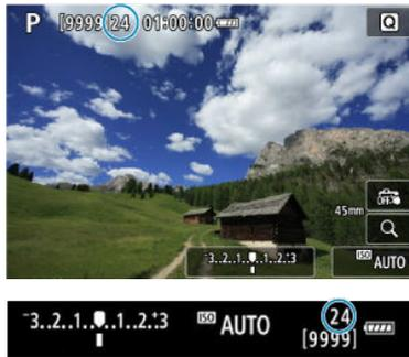
近似最大连拍数量显示在拍摄屏幕的左上方和取景器的右下方。
