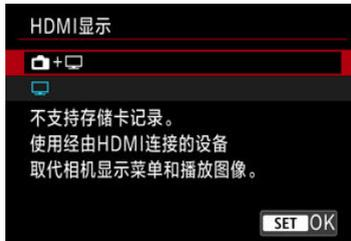
可指定短片通过HDMI记录至外部设备时的显示方式。短片输出对应[短片记录尺寸]设置。
