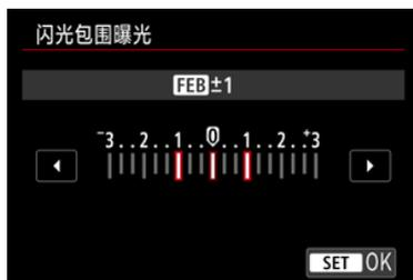
具备闪光包围曝光(FEB)功能的闪光灯可以在一次性拍摄三张照片时自动更改外接闪光灯输出。
