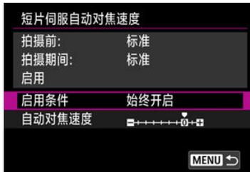
可以设定[始终开启]使自动对焦速度在短片记录时(在短片记录之前和短片记录期间)始终生效，或设定[拍摄期间]使自动对焦速度仅在短片记录期间生效。
