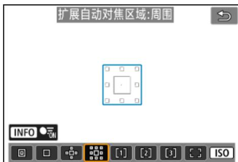
使用一个自动对焦点(☒)和由蓝框包围的周围自动对焦区域进行对焦，与使用扩展自动对焦区域:☒相比，更容易对焦移动被摄体。
