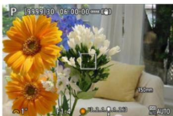
**2.** Після того, як точка АФ стане зеленою, утримуйте кнопку затвора натиснутою наполовину та перекомпонуйте знімок.
