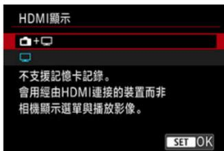
可指定短片透過HDMI記錄至外部裝置時的顯示方式。短片輸出對應[短片記錄大小]設定。預設設定為[📺]。
