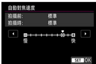
您可從標準速度(0)到慢速(七個級別的其中一級)或從標準速度到快速(兩個級別的其中一級)調整自動對焦速度(對焦轉換速度)，從而獲得創作短片所需的效果。
