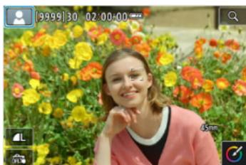
相機偵測場景類型並自動設定所有設定以適合場景。在靜止影像拍攝期間，或在模式轉盤設為<A+>的情況下按下短片拍攝按鈕記錄短片時，畫面左上方會顯示表示偵測到的場景的圖示(📷)。
