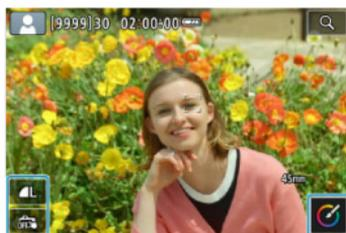
透過輕點畫面上的圖示，可調整驅動模式、影像畫質、輕觸式快門和創意輔助的設定。
