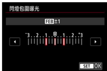
具備閃燈包圍曝光(FEB)功能的閃光燈可以在一次過拍攝三張相片時自動變更外接閃光燈輸出。
