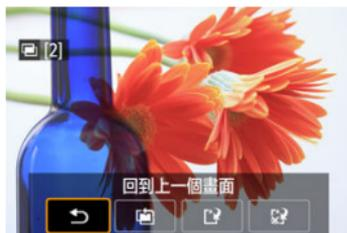
完成所指定曝光次數的拍攝前，按下 <
