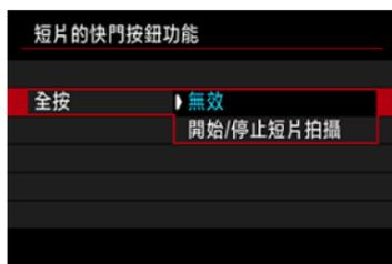
將[全按]設為[開始/停止短片拍攝]時，除了使用短片拍攝按鈕外，可以透過完全按下快門按鈕或使用遙控開關RS-60E3(另行購買)來開始/停止短片記錄。
