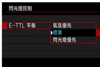
可為閃光燈拍攝設定所需的光線效果(平衡)。此設定可調整環境光照與閃光燈光照輸出的比率。
