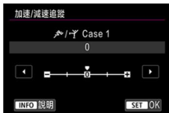
追蹤主體的靈敏度設定，適用於主體突然開始或停止移動等突然大幅變更速度的情況。
