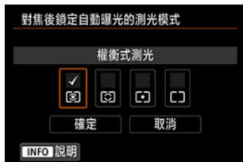
對於每種測光模式，可以指定在使用單次自動對焦合焦主體時，是否鎖定曝光(自動曝光鎖)。持續半按快門按鈕時會鎖定曝光。選擇使用自動曝光鎖的測光模式並添加核取標記[✓]。選擇[確定]註冊設定。
