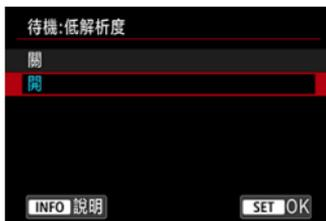
設為**[開]**可節省電池電量並控制待機期間相機溫度升高。從而可能延長短片記錄的持續時間。
