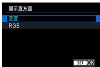
直方圖顯示整個色調範圍的信號量。可進行亮度顯示(用於查看總體的曝光量和整體的色調層次)和RGB顯示(用於查看紅色、綠色與藍色的飽和度和色調層次)。在[▶: 播放資訊顯示]螢幕的左下角中顯示[INFO]時，透過按下< INFO >按鈕可以切換顯示的直方圖。
