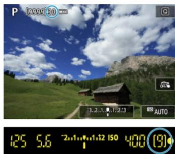
近似最大連續拍攝數量在即時顯示拍攝時顯示在拍攝螢幕的上方，在觀景器拍攝時顯示在觀景器的右下方，以數位或其他標記表示。
