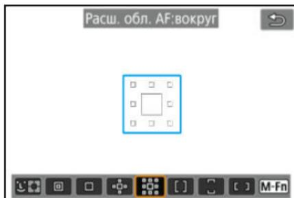
Фокусировка с использованием одной точки AF [ ] и окружающих точек AF, показанных здесь синим цветом, что упрощает фокусировку на движущиеся объекты по сравнению с расширением точки AF: ▪▪▪. Режим Servo AF работает так же, как при расширении точки AF: ▪▪▪.
