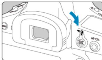
Если при съемке видоискатель не используется (при съемке с автоспуском, с ручной выдержкой или с пультом ДУ), попадающий в видоискатель свет может приводить к недодержке изображения. Во избежание этого закройте окуляр видоискателя, сдвинув рычаг шторки окуляра, как показано стрелкой.
