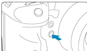
Нажав кнопку предварительного просмотра глубины резкости, можно привести диафрагму объектива в соответствие с текущей установкой и проверить область, находящуюся в фокусе (глубину резкости).
