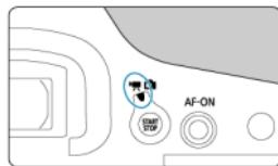
Для видеосъемки установите переключатель «режим Live View/видеосъемка» в положение <>.
