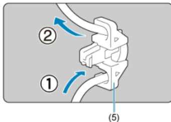
При использовании дополнительно приобретаемого интерфейсного кабеля Canon пропустите кабель через зажим (5), как показано на рисунке, затем установите зажим на устройство защиты кабеля.
