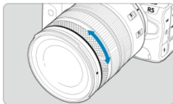
기본 설정으로 [Fv], [P], [Tv], [Av] 또는 [M] 모드에서 셔터 버튼을 반누름한 상태로 유지하고 마운트 어댑터나 RF 렌즈의 컨트롤 링을 돌리면 노출 보정을 설정할 수 있습니다. 그 외에도 [◇: **다이얼의 커스터마이즈**]에서 조작을 사용자 설정하면 컨트롤 링에 다른 기능을 할당할 수 있습니다 (☞).
