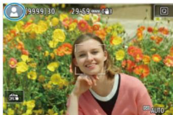
카메라가 장면의 유형을 인식하고 장면에 알맞게 모든 설정을 지정합니다. 인식한 장면 타입은 화면 좌측 상단에 표시됩니다. 아이콘에 관한 자세한 내용은 [장면 아이콘](#)을 참조하십시오.
