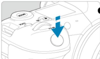
자동 초점 및 셔터 스피드와 조리개 값을 설정하는 자동 노출 시스템이 실행됩니다. 노출값 (셔터 스피드와 조리개 값)이 스크린, 뷰파인더 또는 LCD 패널에 약 8초간 표시됩니다 (측광 타이머/ 8).
