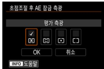
One-Shot AF로 피사체에 초점이 맞았을 때 각 측광 모드에서 노출을 잠금(AE 잠금)할지의 여부를 지정할 수 있습니다. 노출은 셔터 버튼을 반누름한 상태로 유지하는 동안 고정됩니다. AE 잠금을 설정할 측광 모드를 선택한 다음 체크 표시 [✓]를 추가하십시오. [OK]를 선택하면 설정이 등록됩니다.
