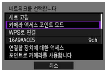
카메라 액세스 포인트 모드는 카메라와 각 기기를 Wi-Fi를 통해 직접 연결하는 접속 모드입니다.
