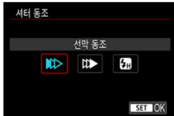
평상시에는 촬영이 시작되면 바로 플래시가 발광할 수 있도록 [선막 동조]로 설정하십시오. 차의 헤드라이트 불빛이 번진 사진처럼 피사체의 움직임이 자연스럽게 표현된 사진을 촬영하려면 [후막 동조]로 설정하고 셔터 스피드를 낮게 설정하여 사용하십시오. 최대 플래시 동조 셔터 스피드보다 더 높은 셔터 스피드로 플래시 촬영을 하려면 [고속 동조]로 설정하십시오. 이 옵션은 예를 들어 [Av] 모드에서 조리개를 개방하여 대낮의 야외에서 피사체 뒤에 있는 배경을 흐리게 촬영하고 싶은 경우에 효과적입니다.
