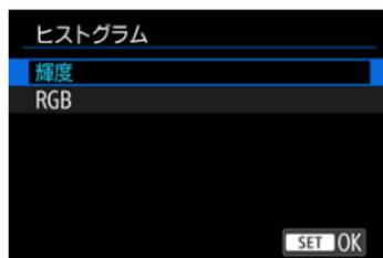
ヒストグラムは、各階調の信号量を表示するものです。露出レベルの傾向と全体の階調を確認できる輝度表示と、色の飽和と階調を確認できるRGB表示があります。[▶]:再生情報表示設定]の画面の左下に[INFO]が表示されているときに、〈INFO〉ボタンを押すと、表示するヒストグラムを切り換えることができます。
