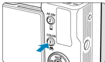
動画撮影、静止画撮影時には、カラーモードの選択画面 (☑) が表示されます。再生時には、事前に設定された検索条件の画像を表示します。
