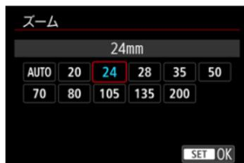
ズーム機能を内蔵したストロボ使用時に、発光照射角を設定することができます。
