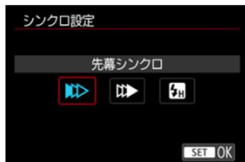
通常は、撮影開始直後にストロボが発光する **【先幕シンクロ】** に設定します。
