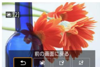
**【機能・操作優先】** 設定時に、設定した枚数の撮影が完了する前に〈▶〉ボタンを押すと、撮影途中の（多重）画像が表示され、重なり具合や、露出などを確認することができます（**【連続撮影優先】**時不可）。
