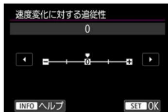
被写体が急に動き出したときや、急に止まったときなど、速さが瞬時に大きく変化したときの、被写体に対する追従性の設定です。
