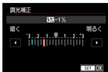
露出補正と同じ感覚で、ストロボの発光量を調整することができます。
