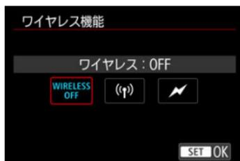
電波通信、または光通信によるワイヤレス多灯ライティング撮影を行うことができます。詳しくは、ワイヤレスストロボ撮影に対応したストロボの使用説明書を参照してください。
