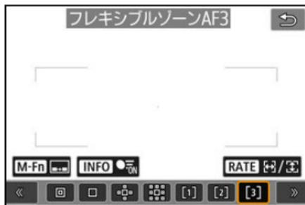
フレキシブルゾーンAF3では、ゾーンAFフレーム [ ] のサイズを自由に設定できます (Ⓜ)。領域拡大AFよりもAF範囲が広い「ゾーンAFフレーム」で自動選択AFを行うため、1点AFや領域拡大AFよりも被写体を捉えやすく、動きのある被写体を撮影するときに有効です。初期状態では、横長のゾーンAFフレームが設定されています。
