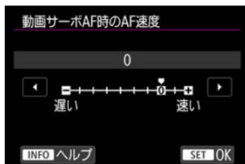
作画意図に合わせてAF速度（ピント送り）を、標準の速さ（0）から遅い方向に7段階（-1～-7）、速い方向に2段階（+1,+2）の調整を行うことができます。
