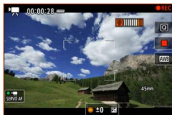
アイコンが点滅している状態で撮影を続けると、メッセージが表示され、カメラの電源が自動的に切れます。
