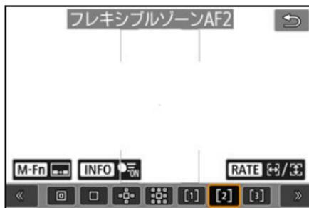
フレキシブルゾーンAF2では、ゾーンAFフレーム[ ]のサイズを自由に設定できます (Ⓢ)。領域拡大AFよりもAF範囲が広い「ゾーンAFフレーム」で自動選択AFを行うため、1点AFや領域拡大AFよりも被写体を捉えやすく、動きのある被写体を撮影するときに有効です。初期状態では、縦長のゾーンAFフレームが設定されています。最も近距離の被写体に限らず、動いている被写体や人の顔、動物の顔、乗り物、被写体距離などのさまざまな条件によってピント合わせの領域を決定します。シャッターボタンを半押しすると、ピントが合ったAFフレームは [ ] で表示されます。
