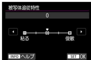
サーボAFで測距中に、障害物がAFフレームを横切ったときや、AFフレームが被写体から外れたときの、被写体に対する追従性の設定です。
