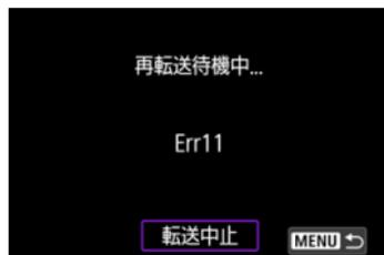
エラーの原因が取り除かれると、転送に失敗した画像が自動的に再転送されます。この自動再転送機能は、撮影時自動転送のときだけでなく、撮影後の画像をFTP転送するときも働きます。なお、転送をキャンセルしたり、カメラの電源を切ったときは、自動再転送されません。
