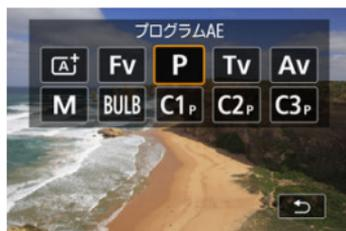
静止画撮影を行うときは、静止画撮影／動画撮影切り換えスイッチを（
