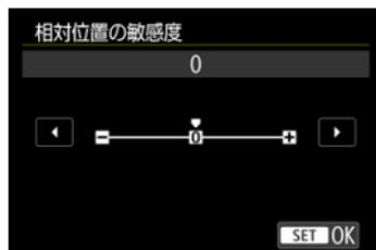
AFフレームの移動量が、+側に設定すると大きくなり、-側に設定すると小さくなります。
