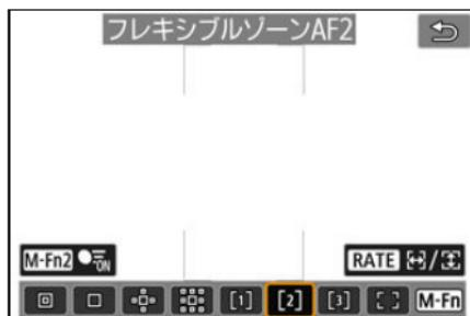
フレキシブルゾーンAF2では、ゾーンAFフレーム〔〕のサイズを自由に設定できます(④)。領域拡大AFよりもAF範囲が広い「ゾーンAFフレーム」で自動選択AFを行うため、1点AFや領域拡大AFよりも被写体を捉えやすく、動きのある被写体を撮影するときに有効です。初期状態では、縦長のゾーンAFフレームが設定されています。
