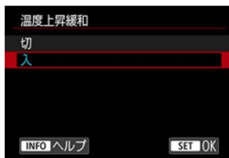
[入] にすると消費電力を抑え、撮影待機状態のカメラ内部の温度上昇を抑えます。これにより動画の撮影時間が長くなることがあります。
