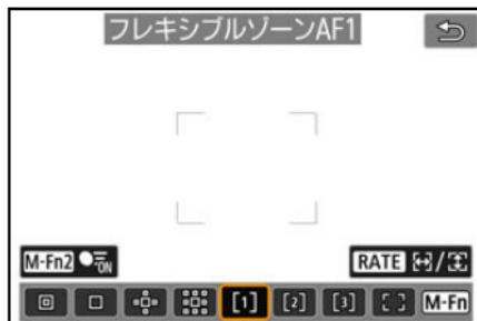
フレキシブルゾーンAF1では、ゾーンAFフレーム〔〕のサイズを自由に設定できます(④)。領域拡大AFよりもAF範囲が広い「ゾーンAFフレーム」で自動選択AFを行うため、1点AFや領域拡大AFよりも被写体を捉えやすく、動きのある被写体を撮影するときに有効です。初期状態では、正方形のゾーンAFフレームが設定されています。
