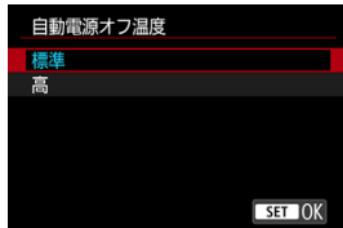
[高] にすると、カードの温度が高くなつた際にカメラの電源が自動的に切れることを抑えます。
