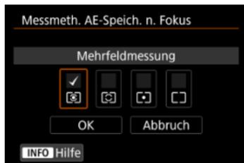
Sie können für jede Messmethode festlegen, ob die Belichtung gespeichert werden soll (AE-Speicherung), sobald sich Motive mit One-Shot AF im Fokus befinden. Die Belichtung bleibt gespeichert, solange Sie den Auslöser halb gedrückt halten. Wählen Sie Messmethoden für die AE-Speicherung und setzen Sie ein Häkchen [✓]. Wählen Sie [OK], um die Einstellung zu registrieren.
