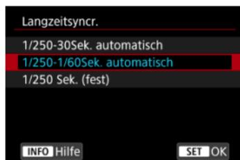
Sie können die Blitzsynchronzeit für Blitzaufnahmen in den Modus <P> oder <Av> einstellen. Beachten Sie, dass die maximale Blitzsynchronzeit von der Kombination der Einstellungen für [📷: **Auslöser-Modus**] und [📷: **Ausschnitt-/Seitenverhältnis**] abhängt.
