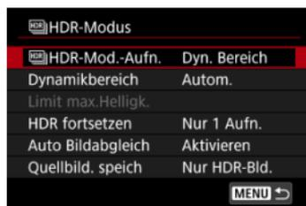
Geeignet für Landschafts- und Stillebenaufnahmen. Für jede Aufnahme werden drei Bilder mit unterschiedlicher Belichtung (Standardbelichtung, Unterbelichtung und Überbelichtung) aufgenommen und automatisch zusammengeführt.
