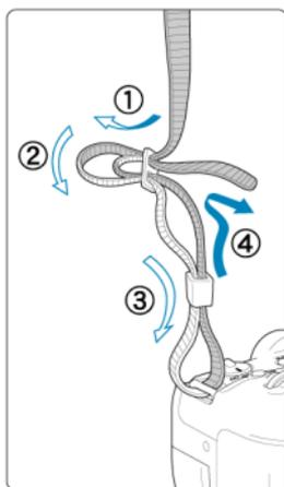
Führen Sie das Ende des Riemens von unten durch die Tragegurthalterung und dann wie gezeigt durch die Riemenschnalle. Ziehen Sie den Tragegurt straff, damit er sich nicht aus der Öse löst.
