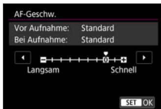
Sie können die AF-Geschwindigkeit (Fokusübergangsgeschwindigkeit) von Standardgeschwindigkeit (0) bis langsam (in 7 Stufen) oder schnell (in 2 Stufen) einstellen, um den gewünschten Effekt bei der Movie-Erstellung zu erzielen.
