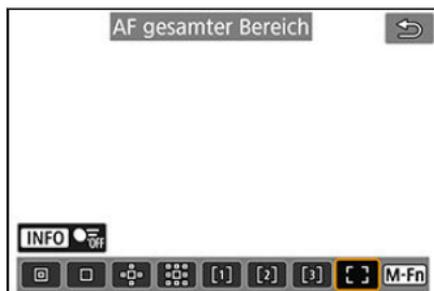
Die automatische AF-Messfeldwahl im Rahmen des Bereichs AF deckt einen größeren Bereich ab als die flexible AF-Messfeldwahl in Zone, was die Fokussierung im Vergleich zum 1-Messfeld-AF/Erweiterung des AF-Messfeld /flexible AF-Messfeldwahl in Zone, erleichtert und bei beweglichen Motiven sehr effektiv ist.
