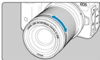
Die Belichtungskorrektur kann eingestellt werden, indem der Steuerungsring der RF Objektivs oder Bajonettadapter gedreht wird, während der Auslöser im Modus <Fv>, <P>, <Tv>, <Av> oder <M> halb durchgedrückt wird. Andernfalls können Sie dem Steuerungsring eine andere Funktion zuweisen, indem Sie die Bedienvorgänge in [Fn: **Wahräder anpassen**] (☑) anpassen.
