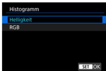
Die Histogramme zeigen die Signalpegel über den Tonbereich. Es stehen eine Helligkeitsanzeige (zur Überprüfung des allgemeinen Belichtungsstufes und der Gesamtabstufung) und eine RGB-Anzeige (zur Überprüfung der Farbsättigung und Abstufung von Rot, Grün und Blau) zur Verfügung. Sie können das angezeigte Histogramm wechseln, indem Sie die Taste <|INFO|> drücken, wenn [INFO] links unten im Bildschirm [▶]: **Auf d. Infobildschirm wiedergeb.**] angezeigt wird.
