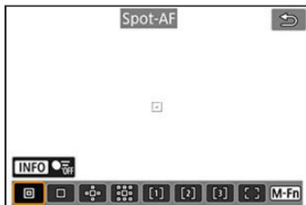
Die Kamera fokussiert in einem kleineren Bereich als Einzelfeld AF.
