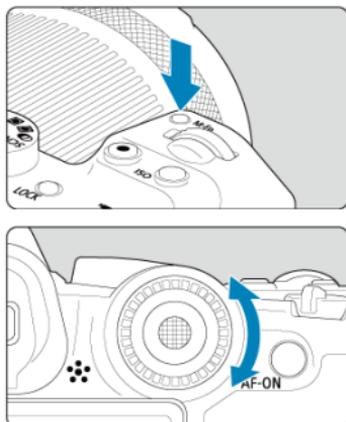
Drücken Sie eine Taste, z. B. **<M-Fn>** oder **<ISO>**, und drehen Sie dann das Wahlrad
