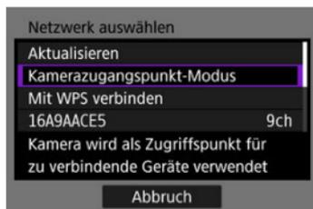
Der Kamerazugangspunkt-Modus ist ein Verbindungsmodus zum Herstellen einer direkten WLAN-Verbindung mit den einzelnen Geräten. Wird angezeigt, wenn [📶], [📶] oder [📶] nach [(?)]: **WLAN/Bluetooth-Verbindung**] ausgewählt ist.
