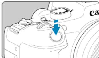
Dies aktiviert den Autofokus und das Belichtungsautomatik-System, mit dem Verschlusszeit und Blendenwert eingestellt werden.
