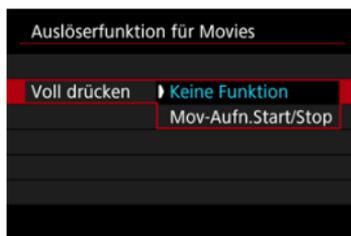
Wenn **[Voll drücken]** auf **[Mov-Aufn.Start/Stop]** eingestellt ist, können Sie die Movie-Aufnahme nicht nur mit der Taste für Movie-Aufnahme, sondern auch durch vollständiges Drücken des Auslösers oder mit dem Auslösekabel RS-60E3 (separat erhältlich) starten/stoppen.
