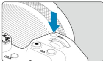
Durch Drücken der Taste <M-Fn> und Drehen des Wahlrads <⦿> können Sie die ISO-Empfindlichkeit (☑), die Betriebsart (☑), den AF-Betrieb (☑), den Weißabgleich (☑) und die Blitzbelichtungskorrektur (☑) einstellen.
