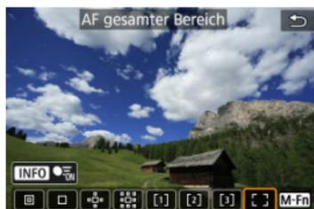
3. Drücken Sie die Taste  $\langle \text{M-Fn} \rangle$  und wählen Sie die AF-Messfeldwahl in Zone 1, 2 oder 3.
