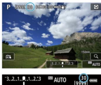
Die ungefähre maximale Anzahl von Reihenaufnahmen wird oben links im Aufnahmebildschirm und unten rechts im Sucher angezeigt.
