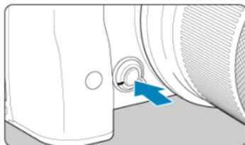
Drücken Sie die Schärfentiefe-Prüftaste, um das Objektiv auf die aktuelle Blendenwerteinstellung herunterzufahren und den scharfen Bereich (Feldtiefe) zu überprüfen.
